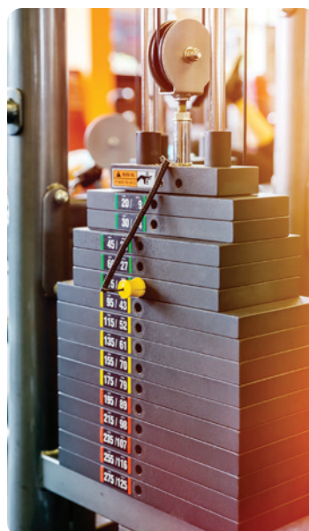
IMAGEM 26: a foto acima mostra como o atleta regula o peso que quer levantar no aparelho que aparece na foto ao lado (apenas mudando esse pino amarelo de lugar).
