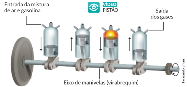
ILUSTRAÇÃO 9: motor a quatro tempos.
