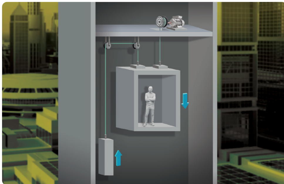
ILUSTRAÇÃO 12: esquema simplificado do funcionamento de um elevador.
