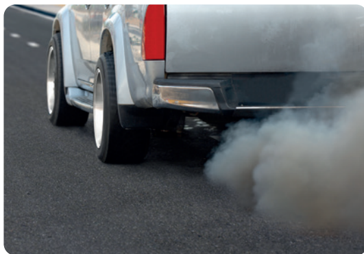
IMAGEM 11: carro com motor desregulado soltando fumaça pelo escapamento (queima incompleta de combustível).
