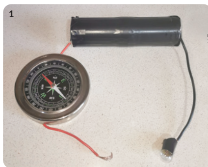
IMAGEM 11: circuito aberto: a bússola aponta para o Norte geográfico.
