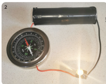
IMAGEM 12: o campo magnético gerado pela passagem de corrente elétrica no fio reorienta a agulha da bússola.
